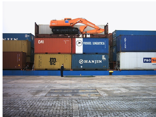
Figura 4: Os contêineres podem ser empilhados; dois contêineres de 20 pés ocupam a mesma área que um contêiner de 40 pés. Fonte: Hamburg Sued.
